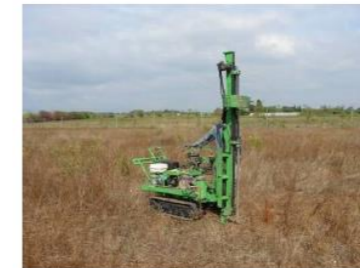
Sondage au pénétromètre
